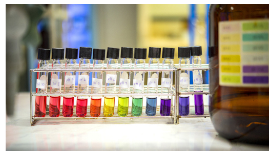
Figur 2. Anvendelse af en universalindikator gør det nemt at se ændringer af pH pga. gæring.
